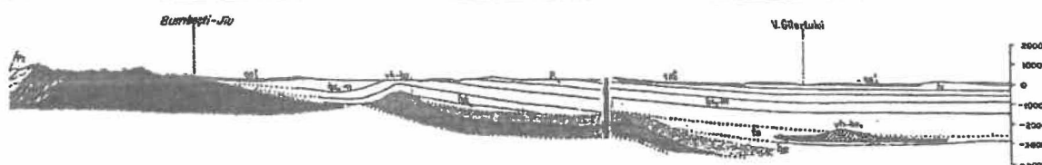
Figura 5. Secțiune geologică prin zona de amplasament
