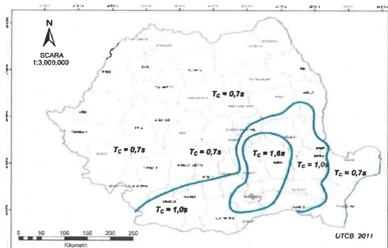
Figura 3.2 Zonarea teritoriului României în termeni de perioada de control (colț), T_c a spectrului de răspuns
