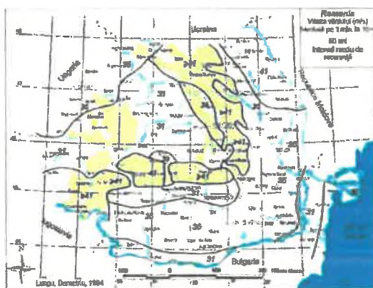
Figura 2.1 Zonarea valorilor de referinta ale presiunii dinamice a vântului, p în kPa, având = 50 ani NOTA. Pentru altitudini peste 1000m valorile presiunii dinamice a vântului se corectează cu relația (A.1) din Anex
